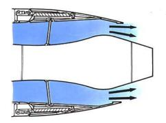
COLD STREAM REVERSER IN FORWARD THRUST POSITION
