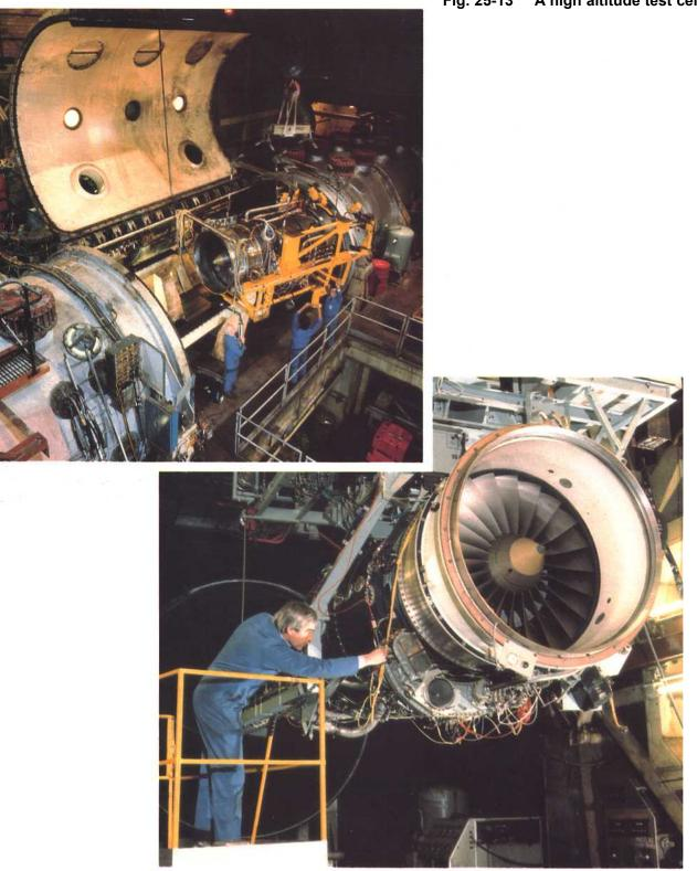
Fig. 25-13 A high altitude test cell.
