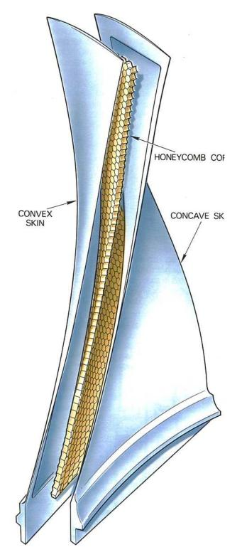
Fig. 22-6 Wide chord fan blade construction.
