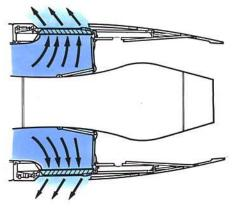
COLD STREAM REVERSER IN REVERSE THRUST POSITION
