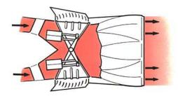
CLAMSHELL DOORS IN FORWARD THRUST POSITION
