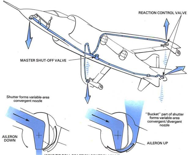
WING TIP ROLL REACTION CONTROL VALVE
