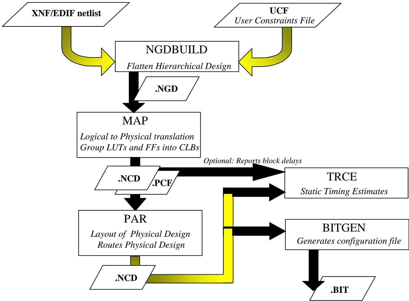
Estrae la netlist dell'intero progetto e controlla gli errori di sintesi
