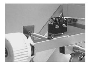
(in figura si vedono i diodi D1 e D3 che sono saldati direttamente sui terminali dello switch per ridurre il n° di fili da cablare)
