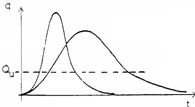
Fig. 3.10 - Onda di piena in entrata al serbatoio di laminazione: ricerca del massimo volume da invasare
