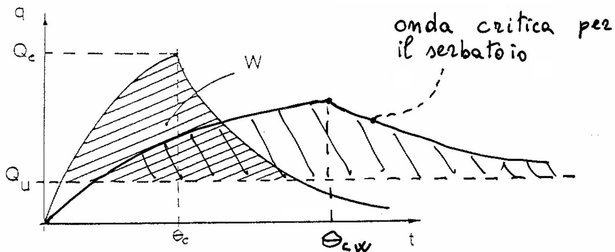
Fig. 3.11 - Onda di piena critica per la rete di fognatura: simbologia
