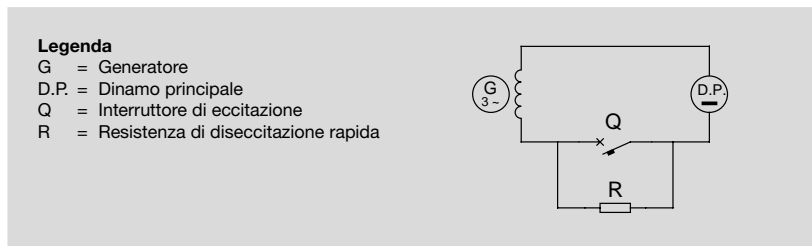
Fig. 15/8 – Circuito di eccitazione di una macchina sincrona con diseccitazione rapida
