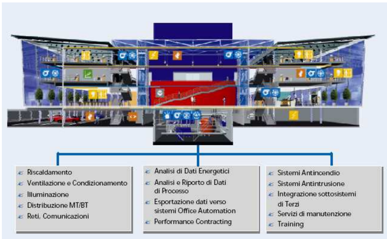
Figura 316: Gestione automatizzata di un intero edificio
