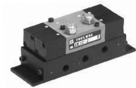
Quando si ha necessità, in presenza di un segnale con bassa pressione, di ottenere un'azione di amplificazione della stessa si usa una valvola amplificatrice composta da una valvola 3/2 monostabile di portata, pilotata da una valvola 2/2. La porzione pilota funziona in depressione. La valvola di amplificazione 3/2 viene commutata intercettando la fuga d'aria tramite la posizione chiusa della pilotina 2/2.
