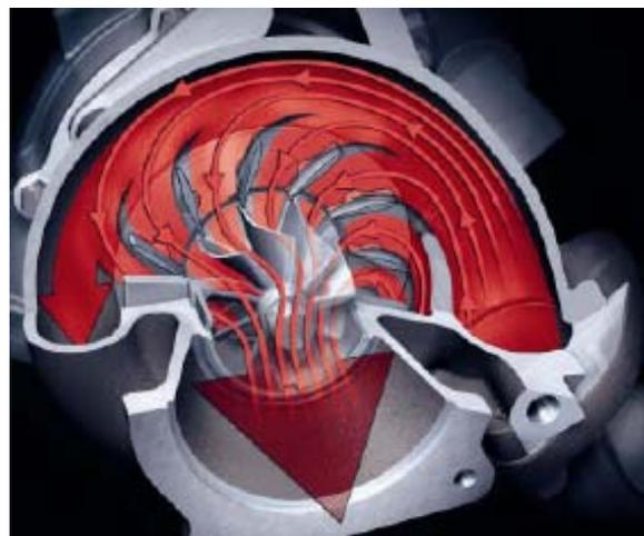
Turbina a geometria variabile (motore a benzina Porsche 911 turbo): a sx configurazione per bassi regimi a dx configurazione per alti regimi
