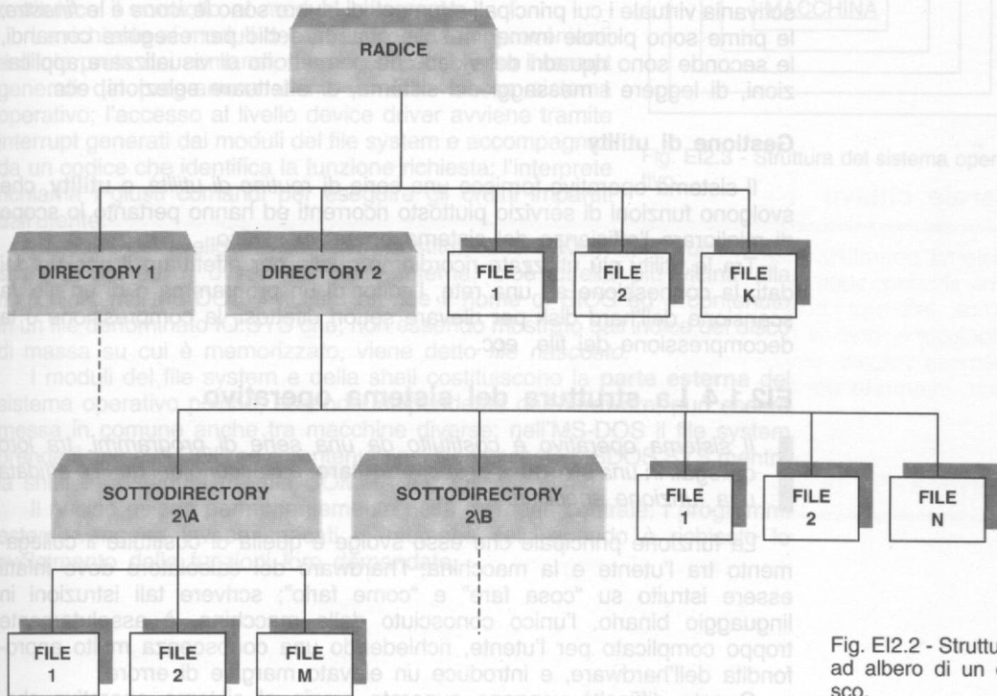
Fig. EI2.2 - Struttura ad albero di un disco.
