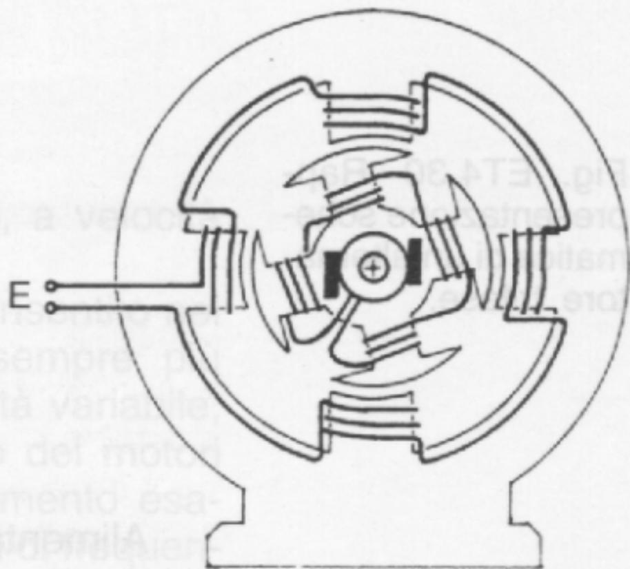
Fig. ET4.29 - Alternatore monofase a quattro poli.
