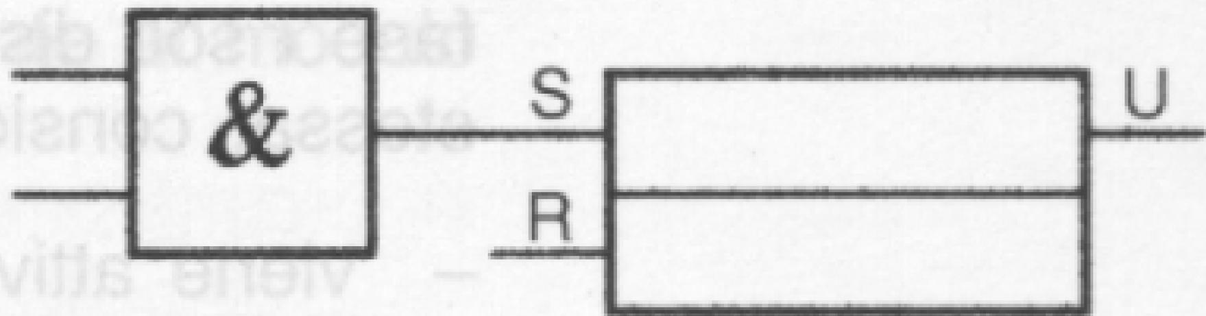
Fig. CP2.137 - Modulo di base per sequenziatore.
